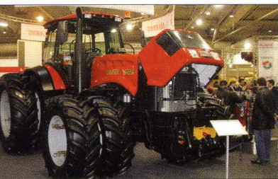
«Белимпэкс Хандельс ГмбХ» в Ганновере представляла тракторы «Беларус» 2822.1 мощностью 280 л.с. фото Г. Палкина
